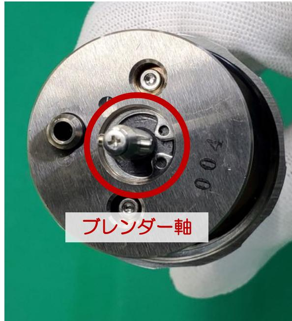
ブレンダー軸を固定して攪拌羽根を反時計回りに回転させて取り外し洗浄する。
