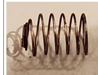
逆止弁のバネに固着せず、詰らない
