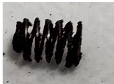
逆止弁のバネにチョコレートが固着し、詰まり発生
