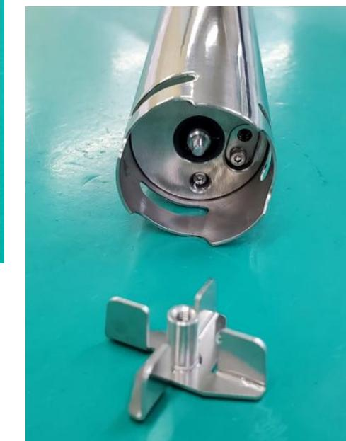
洗浄後の取り付けの際は、攪拌羽根を時計回りに回転させて取りつける。
